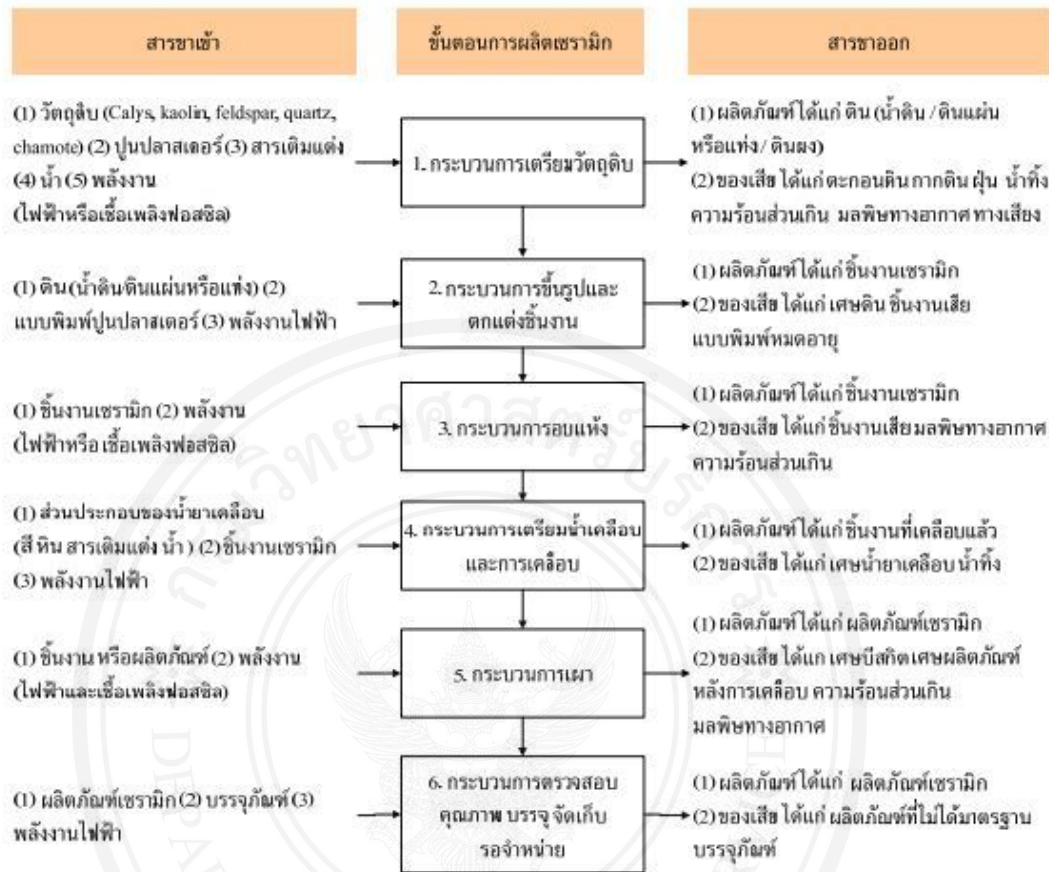
ภาพที่ 8 กระบวนการผลิตเซรามิกในภาพรวม (ที่มา : มูลนิธิสถาบันสิ่งแวดล้อมไทย, 2555)
