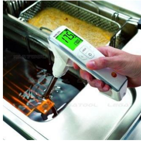
ภาพที่ 4 อุปกรณ์วัดคุณภาพน้ำมัน Cooking Oil Tester
