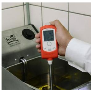
ภาพที่ 3 อุปกรณ์วัดคุณภาพน้ำมัน Food Oil Monitor
